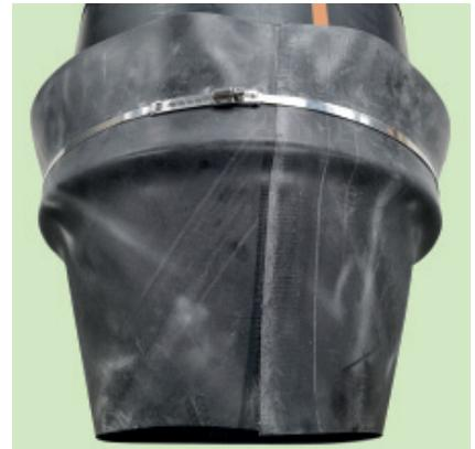
L'extrémité la plus large du joint d'extrémité de tubage est tirée sur le tuyau de tubage jusqu'à ce qu'elle soit bien en place. Une sangle de tension en acier inoxydable est ensuite utilisée pour maintenir le joint d'extrémité en place sur le tuyau de tubage.
