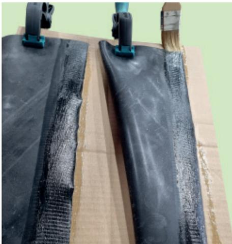
Les bandes de collage (largeur d'environ 30 mm) sont enduites d'une fine couche de l'adhésif fourni. Le temps de séchage de l'adhésif est d'environ 10 à 15 minutes. Un test au doigt est un moyen fiable de s'assurer que le temps de séchage est correct ; l'adhésif doit être sec mais encore collant.
