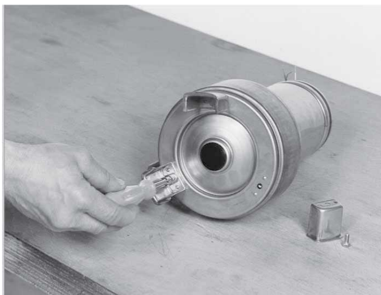
Figure 6 : DX50 (Micro 7TER) : A l'aide d'une clé à douille, desserrer les vis qui maintiennent le pied.
