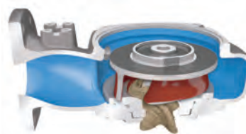
Etape 1 : les aubes de la roue N avec ses bords d'attaque inclinés vers l'arrière guident les solides du centre vers la périphérie de la roue.
