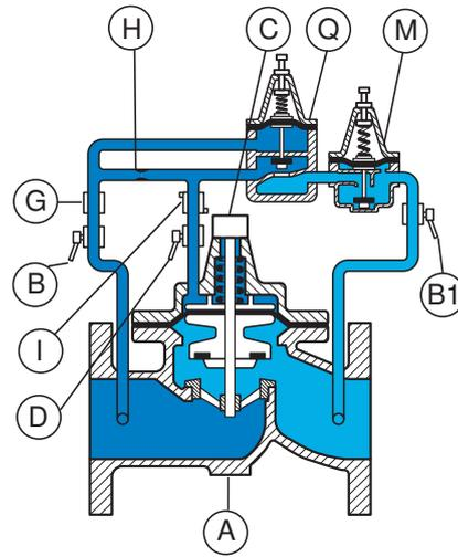
Quand la pression amont devient supérieure à la pression de consigne du pilote (Q), celui-ci reste ouvert et permet la régulation aval par l'intermédiaire du pilote (M).
