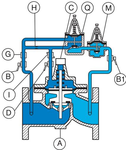
Quand la pression amont devient inférieure à la pression de consigne du pilote (Q) celui-ci tend à se fermer et à limiter le débit traversant. La pression amont s'applique sur la membrane de la vanne principale (A) et tend à fermer celle-ci. La pression amont remonte jusqu'à la consigne du pilote (Q).
