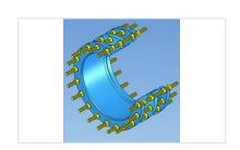
L'installation s'effectue à l'aide de tiges filetées passantes à 100% des trous des brides, qui devront arriver jusqu'à la bride de la vanne ou de l'accessoire, à côté duquel sera installé le joint de démontage. La boulonnerie utilisée pour le montage sur chantier correspond à la quantité de la bride DIN utilisée. Sa longueur devra être suffisante pour que les extrémités de la boulonnerie dépassent au minimum de 1 centimètre des boulons extérieurs.
