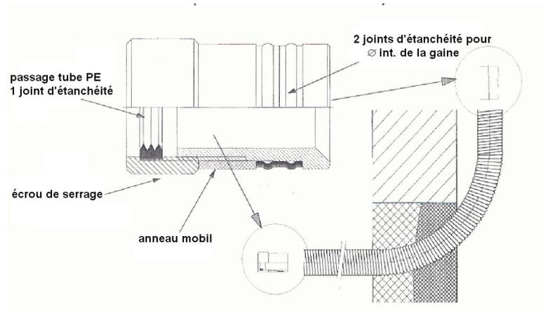
Pièce en P.V.C. destinée à assurer l'étanchéité entre la gaine annelée/lisse et le tuyau de branchement particulier PE. L'étanchéité sera assurée via trois joints en caoutchouc, un anneau et un écrou de serrage. Pièce à poser aux deux extrémités de la gaine.
