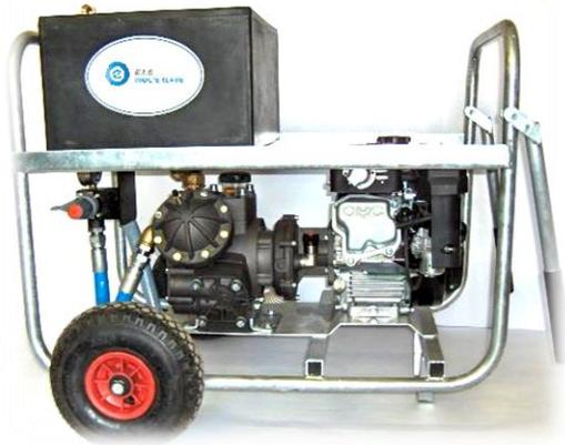
L'ensemble est composé d'une pompe à membranes alimentée par un réservoir d'eau, entraînée par un moteur thermique. Le tout assemblé sur un châssis équipé de roues de grand diamètre et de poignées escamotables pour faciliter son déplacement. Le démarrage est assuré par un lanceur à corde. Réglage de la pression manuelle.
