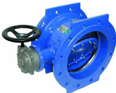
Robinet à papillon BB (bride-bride) avec joint dans le papillon automatique (JPA) à double excentricité et écartement long entre brides.
