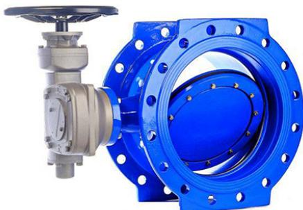
Robinet à papillon BB (bride-bride) avec joint dans le papillon automatique (JPA) à double excentricité et écartement long entre brides.
