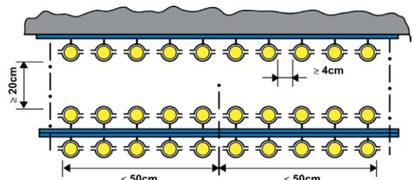
Exemple de tuyaux de gaz accessibles fixés à un plafond.
