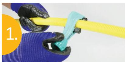
Couper le tuyau PLT FLEXGAZ à l'aide du coupe tube fournis par le fabricant. Couper à travers la gaine synthétique et le tube en acier inoxydable avec un coupe-tube à molette en acier tranchant. Couper le tube en creux d'onde puis faire tourner la coupe tube dans une seule direction en resserrant la molette de pression progressivement après chaque rotation. Ne pas serrer trop fort le coupe-tube sinon vous risquez de déformer l'extrémité du tuyau.
