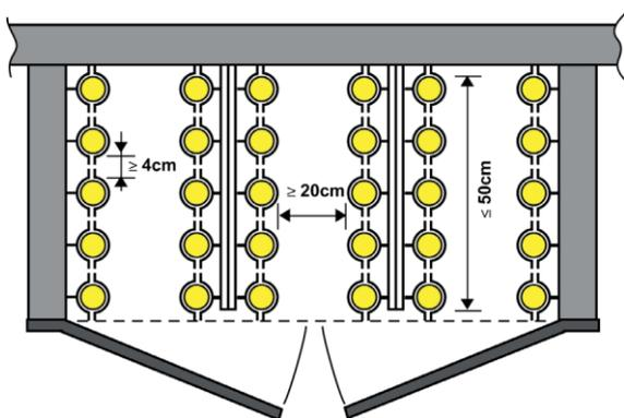
Exemple de tuyaux de gaz accessibles placés dans une gaine technique
