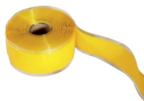
Bande de protection FLEXGAZ est une bande autovulcanisante en silicone. Elle permet une entière étanchéité à l'eau, aux acides et aux rayons UV. Elle doit être appliquée sur les zones dénudées de l'acier inoxydable à la jonction tuyau/raccord ou sur les parties de tuyau mise à nu.
