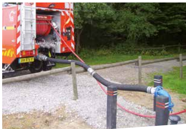
Pompage par véhicule d'intervention du SDIS
