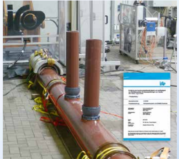
Essai d'hydro-curage Iro 19523
