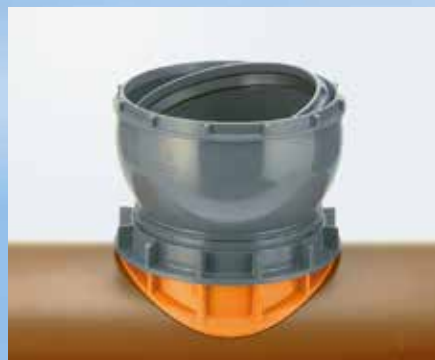
Raccord de piquage CONNEX DN/OD 160/162 sur un tuyau HSK, perçage 162 ± 1 mm
