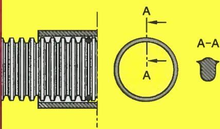
Joint d'étanchéité profilé en élastomère
