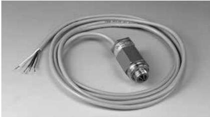
Capteur de détection de présence d'eau basé sur un système opto-électronique, non invasif et sans pièces en mouvement. Le capteur fournit un contact électronique (on/off) à utiliser pour arrêter l'électropompe en cas d'absence d'eau dans la zone de la garniture mécanique.
